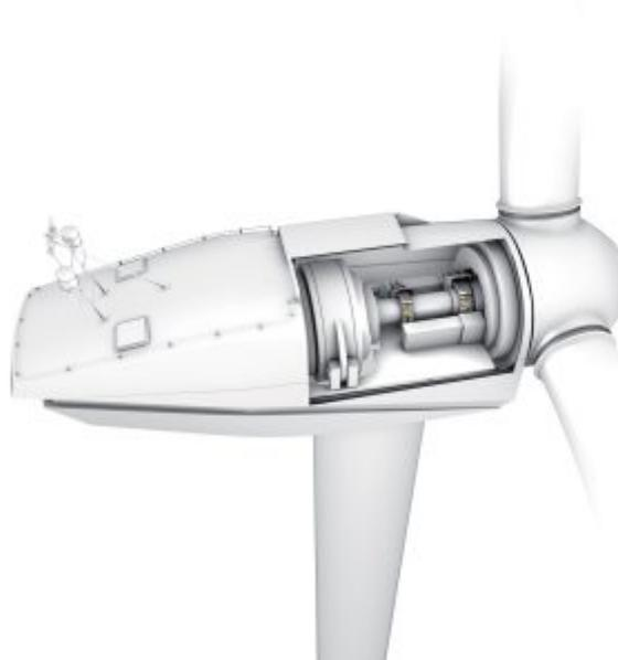
*Die Windenergiebranche stellt ein facettenreiches Einsatzgebiet von Wälzlagern dar. Lagerungsstellen sind Hauptrotorlagerungen, Lagerungen für Verstellgetriebe, Blatt-, Getriebe- sowie Turmlager.*
