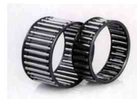
*Es sieht so aus, als sei die Fertigung des Lagers noch nicht abgeschlossen. In Wirklichkeit übernehmen bei Nadelkäfigen aber Welle und Gehäusebohrung die Funktion der Lagerlaufbahnen.*
