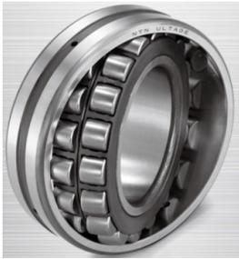
*Leicht aus der „Fassung“ zu bringen: Pendelrollenlager können sehr weit ausschwenken, ohne dass es zu erhöhten Hertzschen Pressungen im Randbereich der Wälzkörper kommt.*
