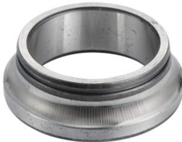
*Bei der Elektroerosion ist ein Stromdurchgang im [Wälzlager](#) für die Entstehung von Schäden verantwortlich, wie ihr anhand dieses [Schrägkugellagers](#) erkennen könnt.*
