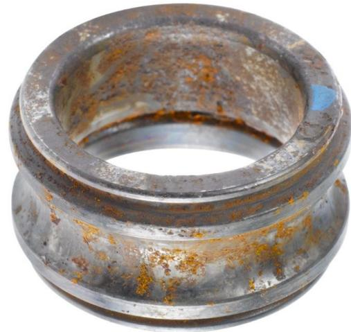
*Der Ring eines **Rillenkugellagers** ist von Korrosion in Form von Rost betroffen - entstanden durch Eindringen korrosiver Medien wie Wasser ins Wälzlager.*
