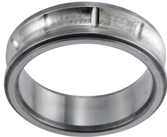
*Am Beispiel dieses Lagerrings sind Stillstandsmarkierungen zu erkennen. Diese wurden durch Vibrationen während eines Stillstands des Wälzlagers verursacht.*
