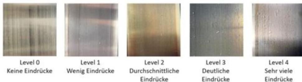
*Die Intensität der Verformungen lässt sich in mehrere Level unterteilen.*
