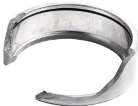
*Dieser Ringbruch am Beispiel eines [Zylinderrollenlagers](#) kann unter anderem durch Schläge, Überlastung oder Biegelasten entstanden sein.*
