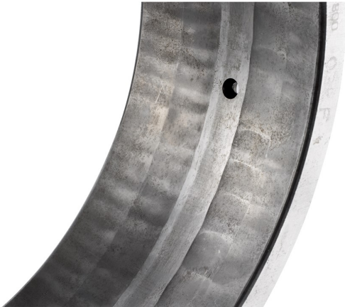
Dieses Beispiel zeigt ein Abschleifen des Materials auf der Laufbahnoberfläche.
