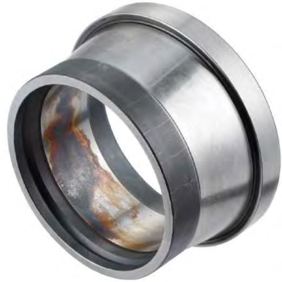
Dieser Innenring ist von Passungsrost betroffen.
