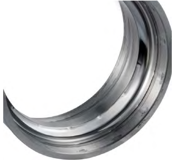
Hier sind Verformungen am Beispiel eines Lagerrings ersichtlich.
